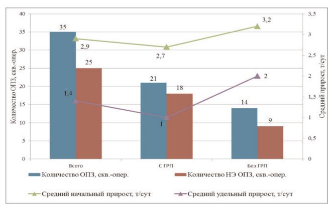
Рис. 3. Эффективность ОПЗ в горизонтальных скважинах объекта АВ
