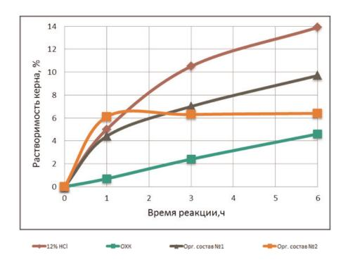
Рис. 4. Динамика растворения керна соляной кислотой и составами на основе органических кислот
